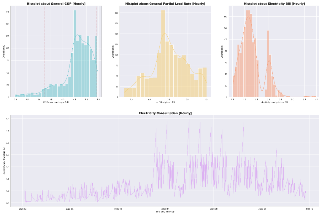
图 5.25 现有冷机配置在设计阶段的能耗情况
