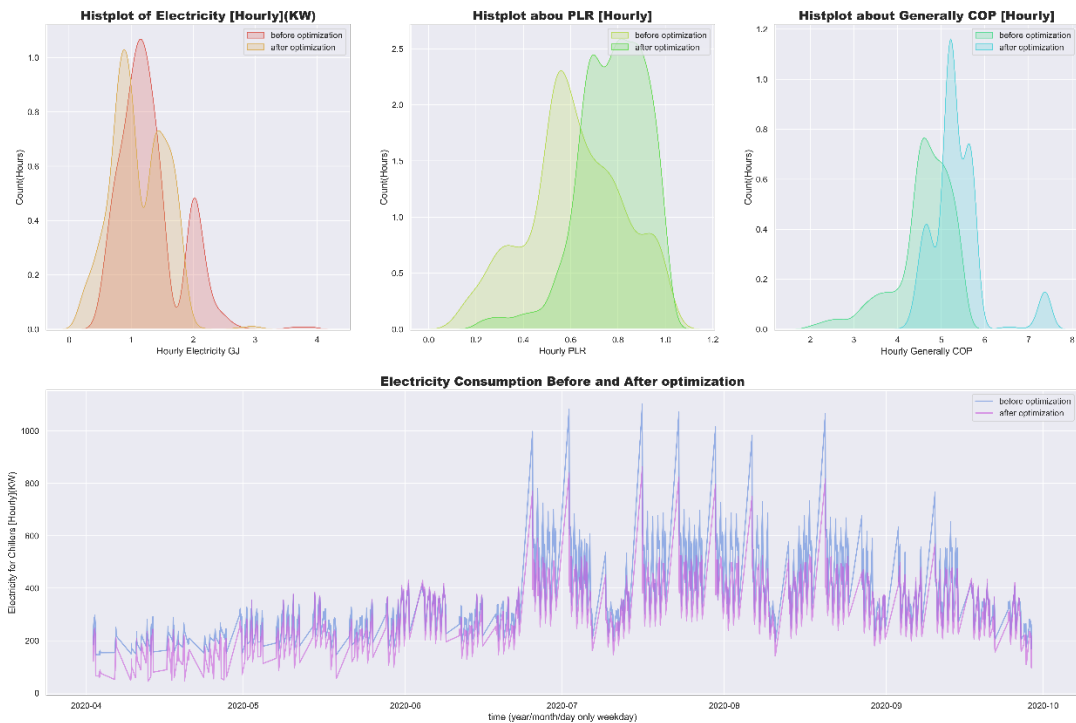
图 5.26 优化前和优化后冷机配置在耗能、PLR、COP 上对比
