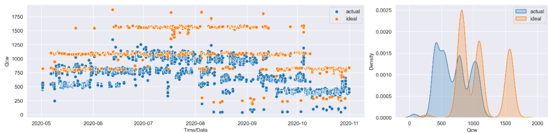
图 5.50 系统运行时冷冻水主干实测流量和理想工况下的流量关系
