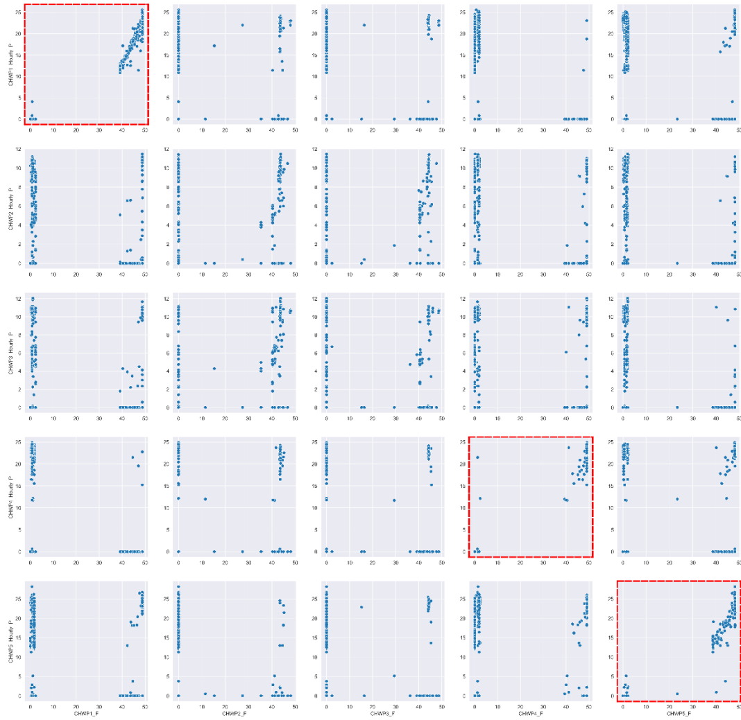
图 5.39 处理前（上）和处理后（下）冷冻水泵频率和功耗的标签对应关系图
