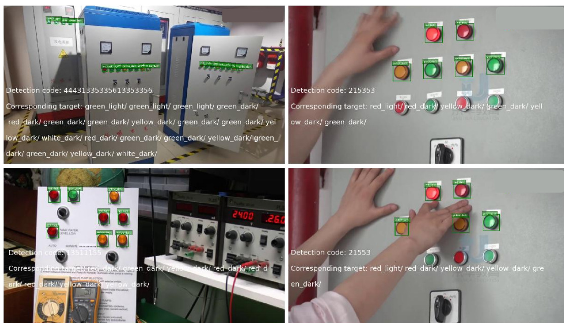
图 4.4 指示灯识别诊断效果图
