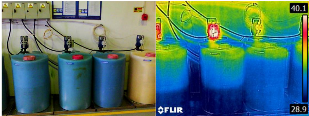
图 3.5 加药箱自然图像与热成像
