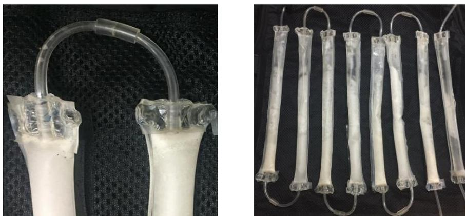
图 2.9 相变材料封装及冷水管敷设完成效果图
