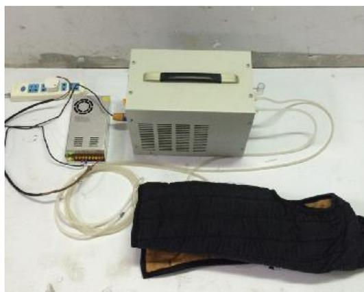
图 5.4 相变液冷服蓄冷实验情景
