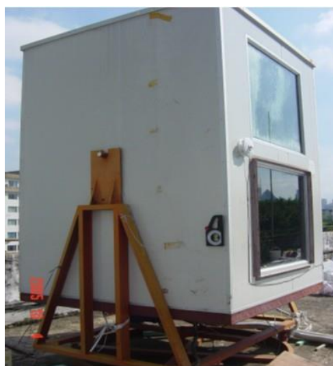
图 1. 5 遮阳系数测试实验装置图
