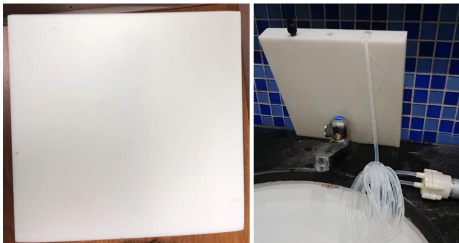
图 3.7 换热器成品及注水检验是否漏水
