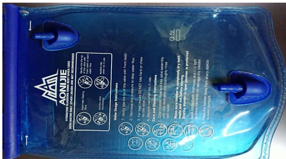
图 7.4 软水带改造方案②（开偏了是避免水袋表面印字对其黏贴密封性造成影响）
