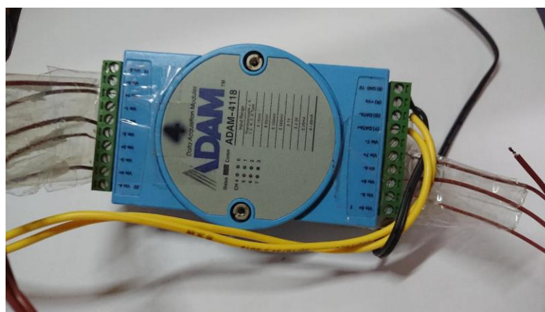
图 9.1 热电偶配合 ADAM-4118 数据采集仪
