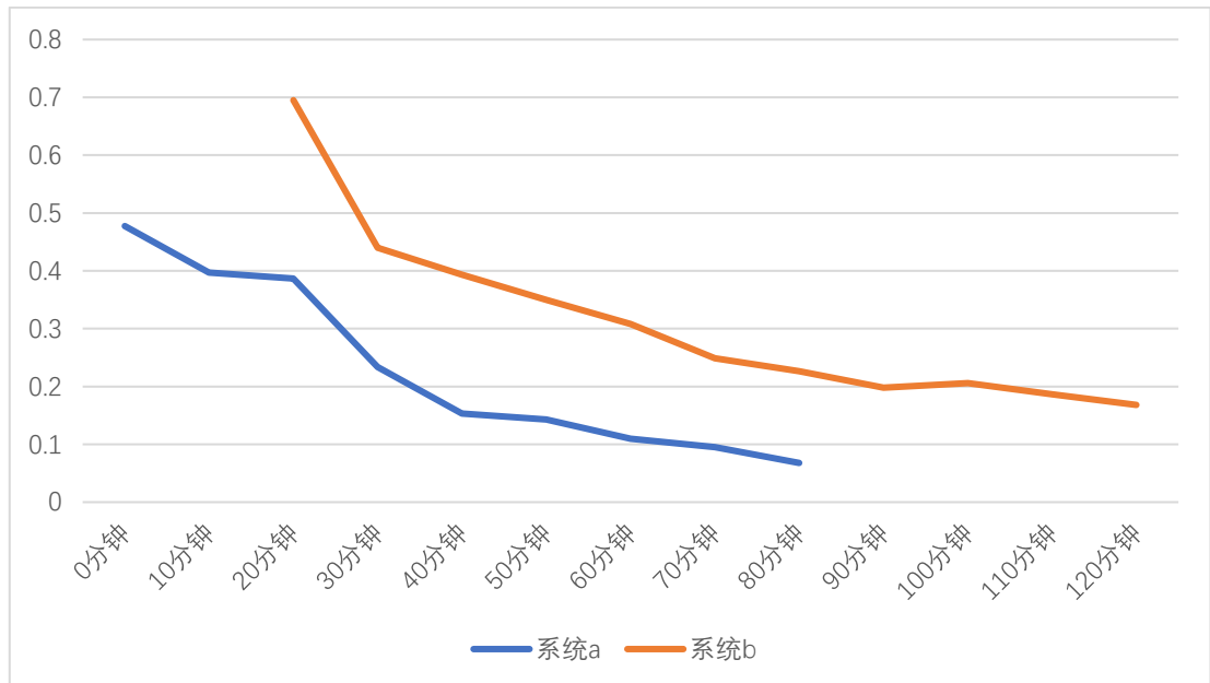
图 9.11 两系统各时刻换热器效能
