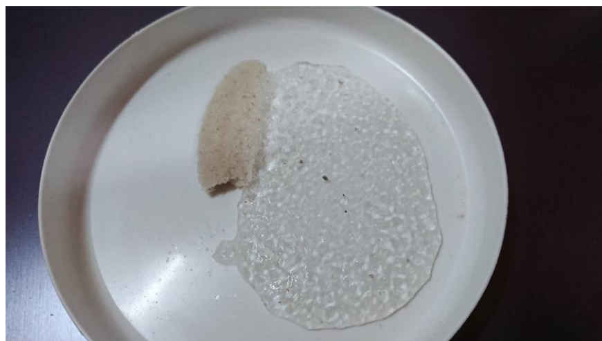
图 7.6 相变凝胶（左侧沙状为吸水前，右侧凝胶状为吸水后）
