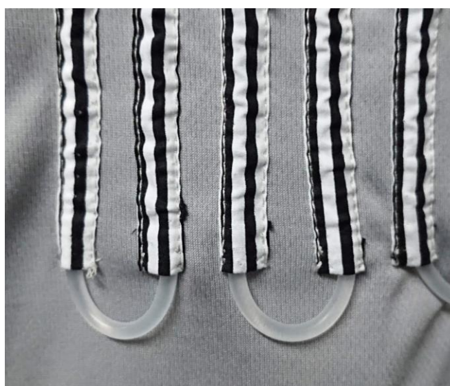
图 4.2 在空调服内侧，缝制内衬，用以固定管路
