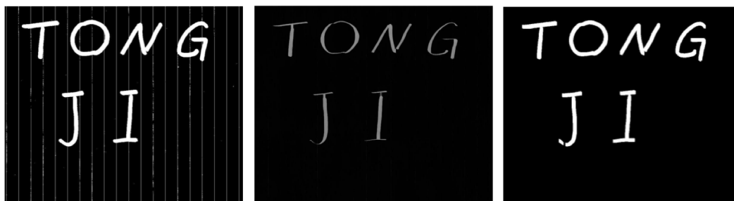
图 2.20 自左到右依次为 1) “TONGJI”原图 2) 腐蚀操作后图像 3) 最终处理图像
