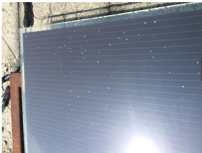
图 5.34 光伏板表面的褐斑
