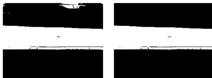
图 3.5 连通域处理前图像 (左) 和连通域处理后图像 (右)
