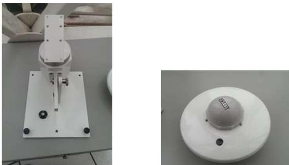
图 58 直射辐射仪（左），全辐射仪
