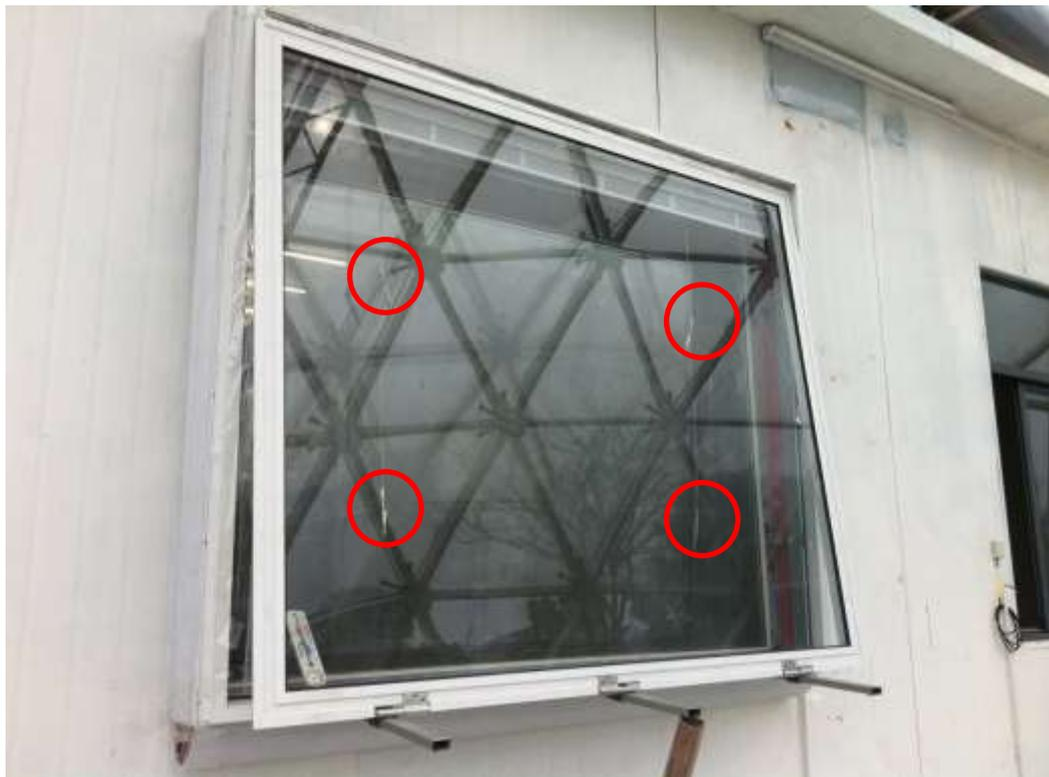
图 50 呼吸窗空腔的温度测点（图中红色圈出）
