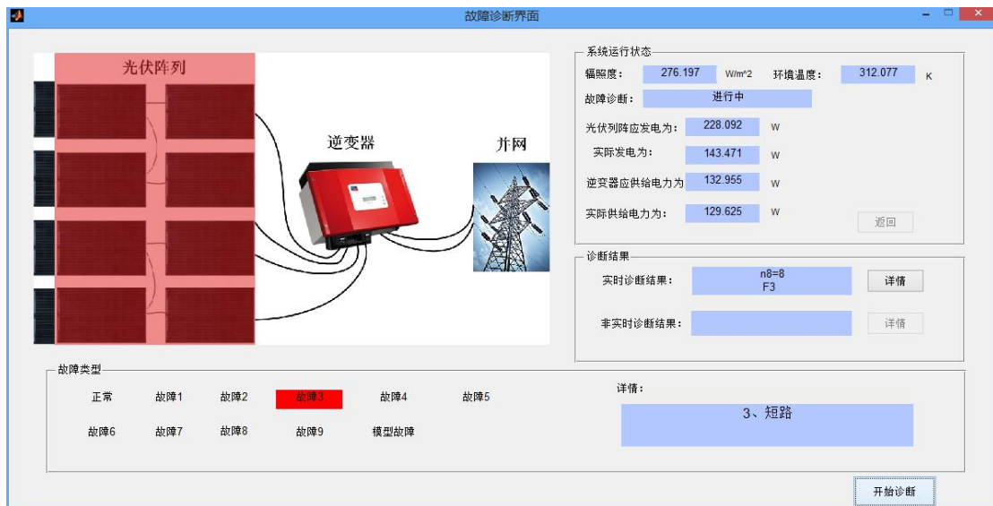
图 5-32 光伏板被短路实验的故障诊断软件输出结果
