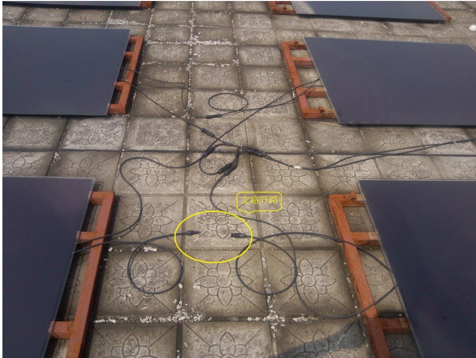
图 5-3 一条支路开路实验的故障方式
