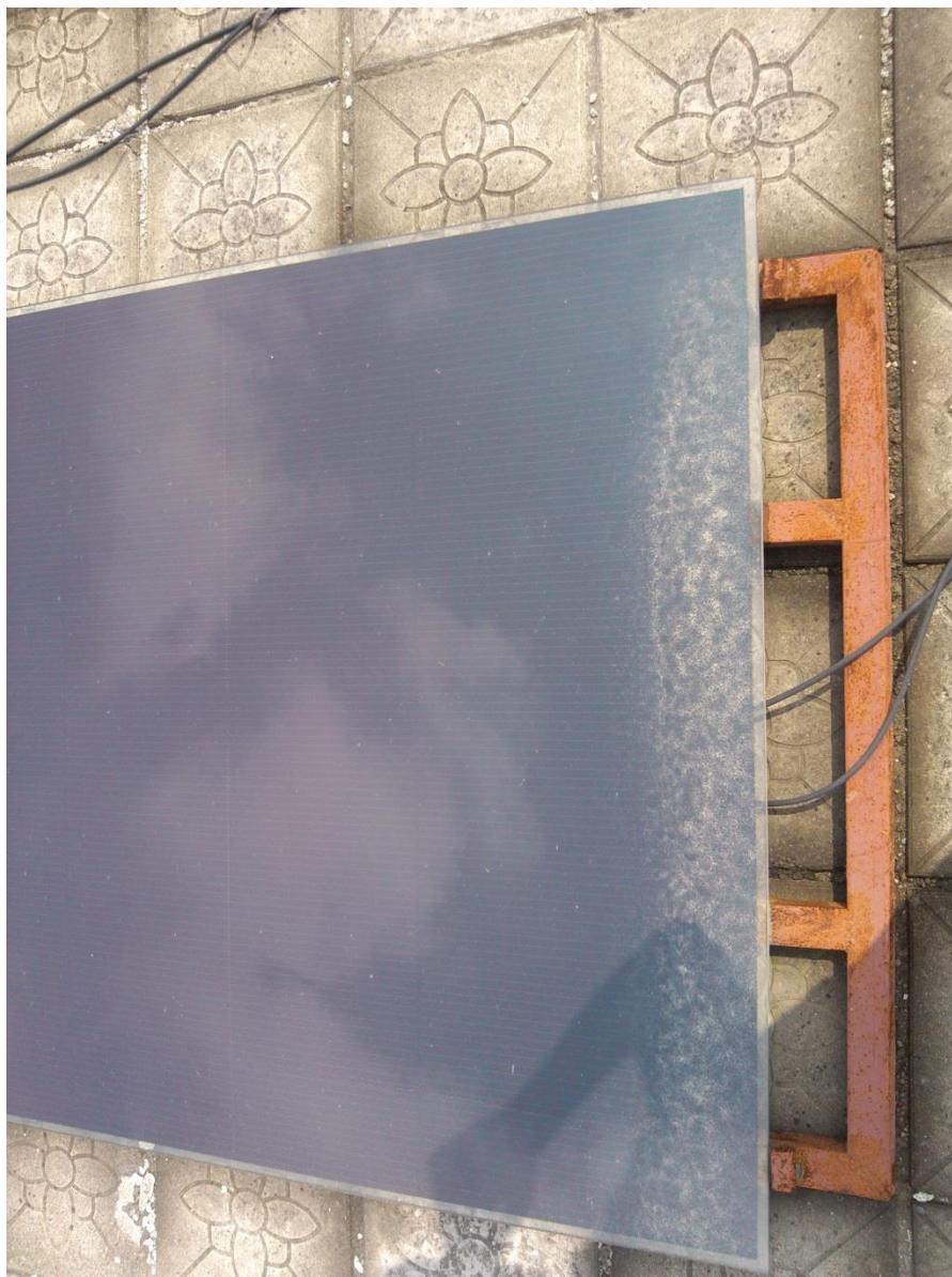
图 5-48 老化、积灰和污物实验的故障方式
